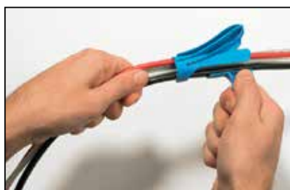
1. Junte todos los cables e introdúzcalos en la herramienta de aplicación.
