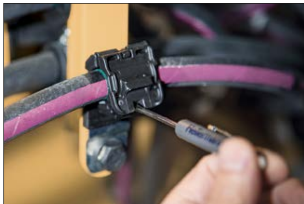
Clevă P cu clichet - o modalitate mai versatilă de a monta și prinde cablurile cu cleva.
