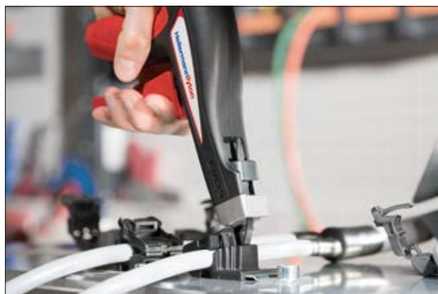
Fașetă tensionată ce poate fi utilizată pentru a asigura o tensiune specifică
