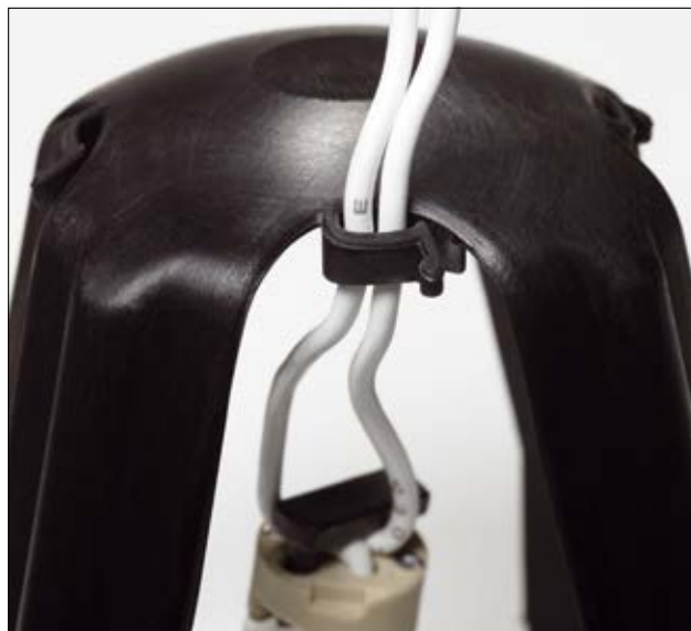
Kabelové úchytky na horní, tepelně nepropustné straně přidrží napájecí kabel osvětlení v určené poloze.
