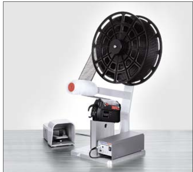
Namizni komplet CPK s pedalom (na sliki tudi: orodje Autotool 2000 CPK, Power pack CPK in T18RA3500).
