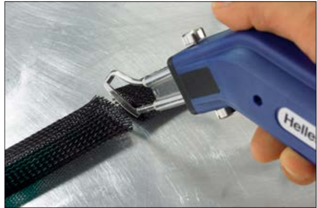
Z uporabo orodja za vroče rezanje HSG0 preprečite cefranje pletenic.
