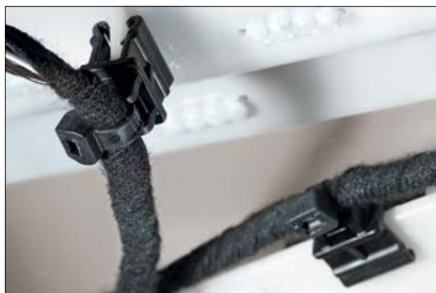
T50ROSEC10 nameščen na plastični plošči, kjer drži snop premera 6 mm.
