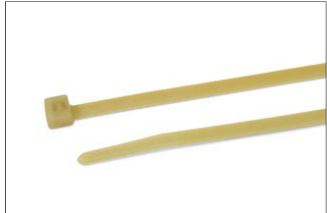
Precintos Serie T - resistentes a Muy Altas Temperaturas hasta +195°C durante 500 (PA46).
