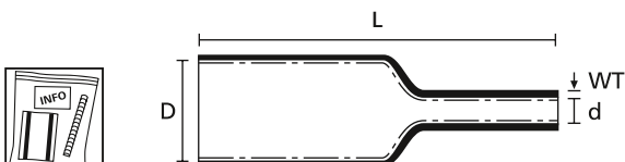
Warm Schrumpfschlauch, Schrumpfrate 4:1 mit Innenkleber
