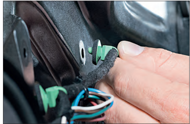
密封圈可保护线束以防水汽进入。
