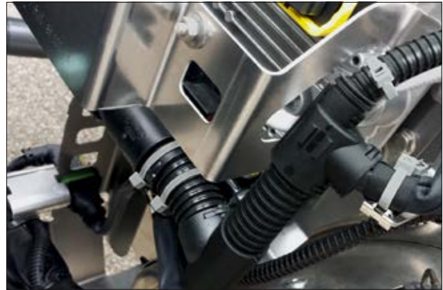
Anwendung von PA46 Kabelbindern an einer Abgaseinheit eines LKW.
