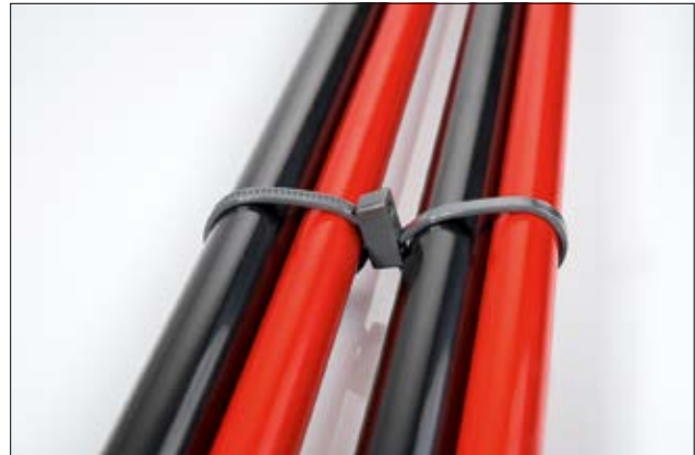
Parallele Bündelung mit Kabelbindern der DH-Serie. Es entsteht eine innen- und eine außenverzahnte Schlaufe durch den Doppelkopf.
