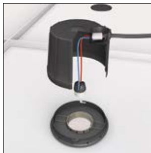
2. Stromführende Verbindung mit HelaCon Lux Steckklemmen herstellen und verschließen der SpotClip-Box mittels Bajonett-Verschluss.
