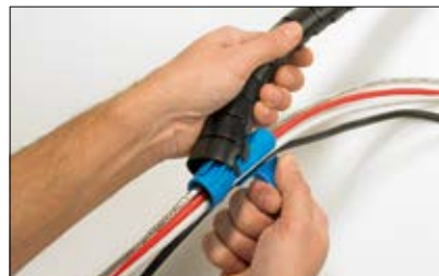
Helawrap auf das Werkzeug aufstecken.
