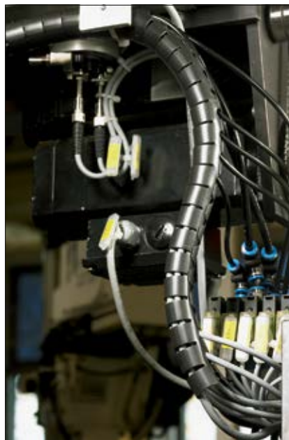
Flexibel auf ganzer Länge - Kabelabzweigungen an jeder Stelle möglich.
