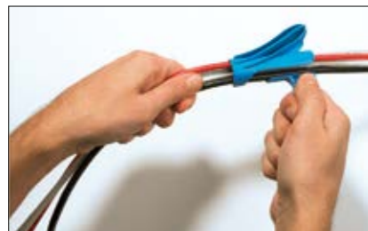
Ledningerne placeres i applikatorens åbning.
