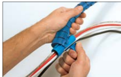
Placer applikatoren i den ene ende af Helawrap slangen.
