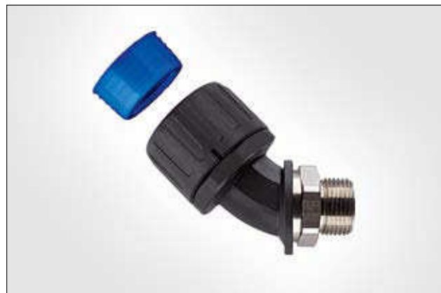
HelaGuard HGL-45M fitting 45° med svivel med udv. gevind, IP68.
