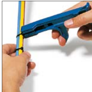
Sæt værktøjet på og stram kabelbinderen.
