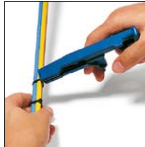
Drej værktøjet og resten af kabelbinderen klippes af.
