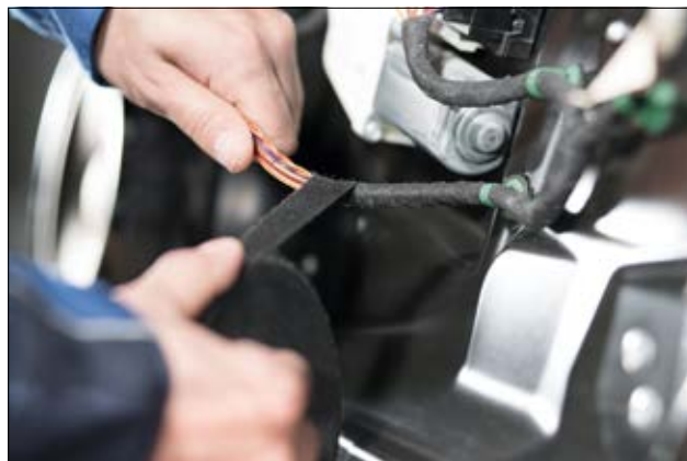
HelaTape Protect 250 er udviklet til ledningsnet med kraftig temperaturpåvirkninger.
