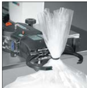
Lukning af poser med ATS3080 montagebænk.
