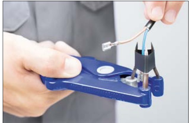
Hurtig og sikker montage med det 3 dornede ekspansionsværktøj.
