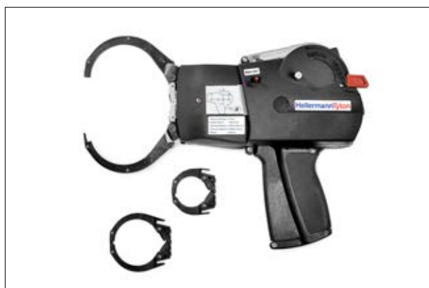
Autotool system 3080 med tre forskellige kæber - optimering af montagetiden ved forskellige bundtdiametre.
