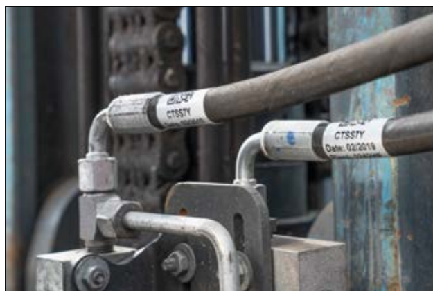
Helatag 1232- selvlaminerende label, modstandsdygtig overfor alkohol og hydraulisk olie.
