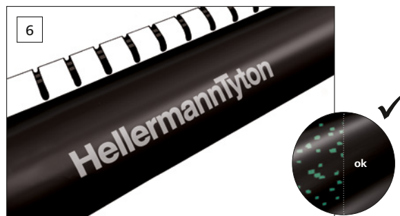
A megfelelő zsugorítási folyamat ellenőrzéséhez- különösen az alsó részeken- ellenőrizze, hogy az összes jelölő pont (TCP) eltűnt-e és a zsugorcső végeken megjelent-e a kifolyt ragasztó.
