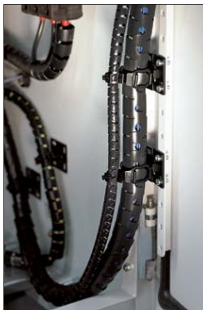
Kábelek védelme és rögzítése Helawrap spirálcsővel és tartozék készlettel, pl. húzószerszámokban.
