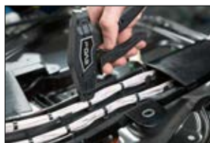
A abraçadeira pode ser cortada em qualquer parte da fita.
