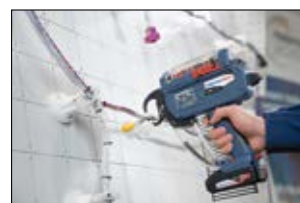
Autotool CPK hybrid aplicando abraçadeiras em bandoleira.
