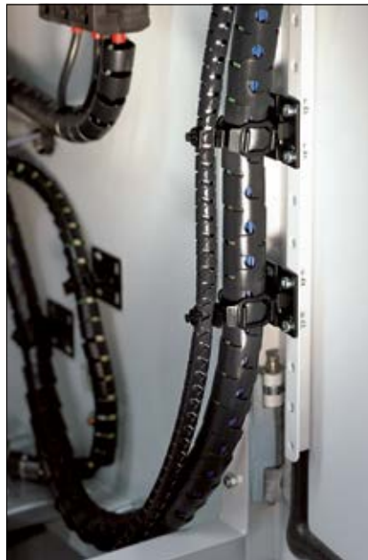
HWPP se pogosto uporablja tam, kjer je potrebna fleksibilnost, recimo na vratih električnih omaric.
