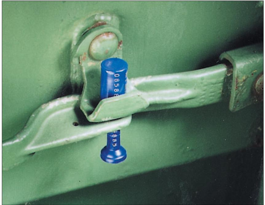
Bolzenplombe BZPL in Anwendung an einem Seecontainer
