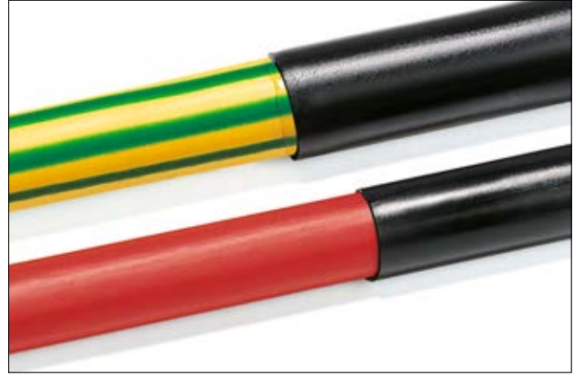
TA32 ve TA42, UL224 sertifikalı yapışkanlı makaronlardır. 3:1 ve 4:1 daralma oranında mevcuttur.
