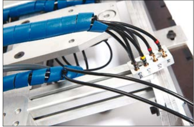
Algılanabilir, metal içerikli spiral bağlama, gıda işleme makinelerindeki kabloları korur.
