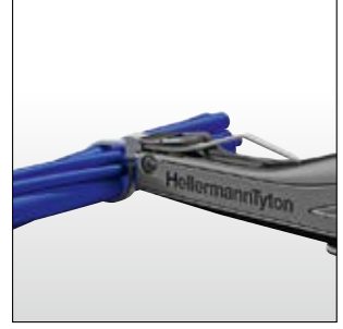
4. Burun parçasının ön kısmını kablo bağının baş kısmıyla aynı hizaya getirin.
