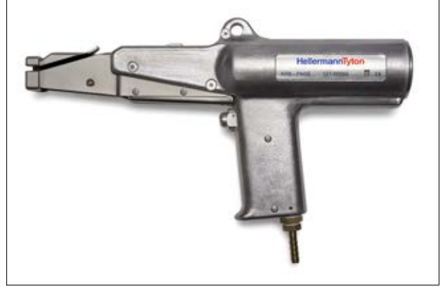
KR8-Serisi kablo bağları için pnömatik germe aleti KR8PNSE.
