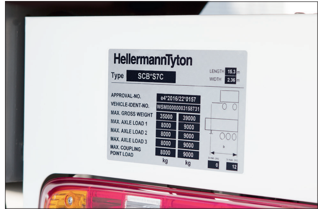
带有防护层板的 HGV 的铭牌。
