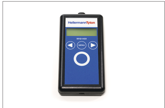
RFID-HS9BT-HF: 高频 (HF) 应答器的手持读写器。
