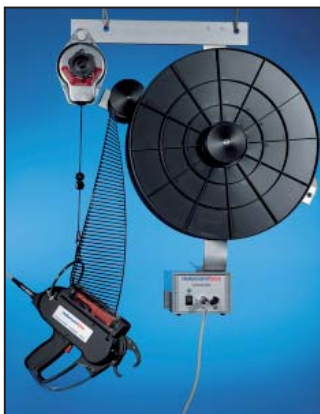
AT2000 mit Aufhängevorrichtung für die mobile Anwendung. Sekundenschnelles Anbringen der Kabelbinder.
