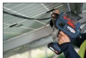
CPK hybrid - przenośne narzędzie do szybkiego wiązania opaskami kablowymi na farmach fotowoltaicznych.
