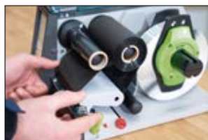
Łatwa aplikacja taśm barwiących w drukarkach termotransferowych HellermannTyton.
