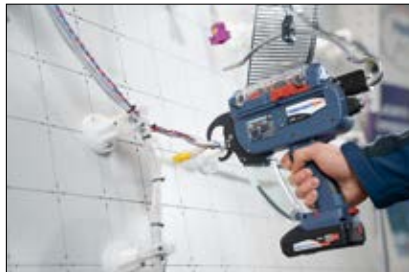
Werkt met accu, bundelbanden op een haspel aan een ophanginrichting
