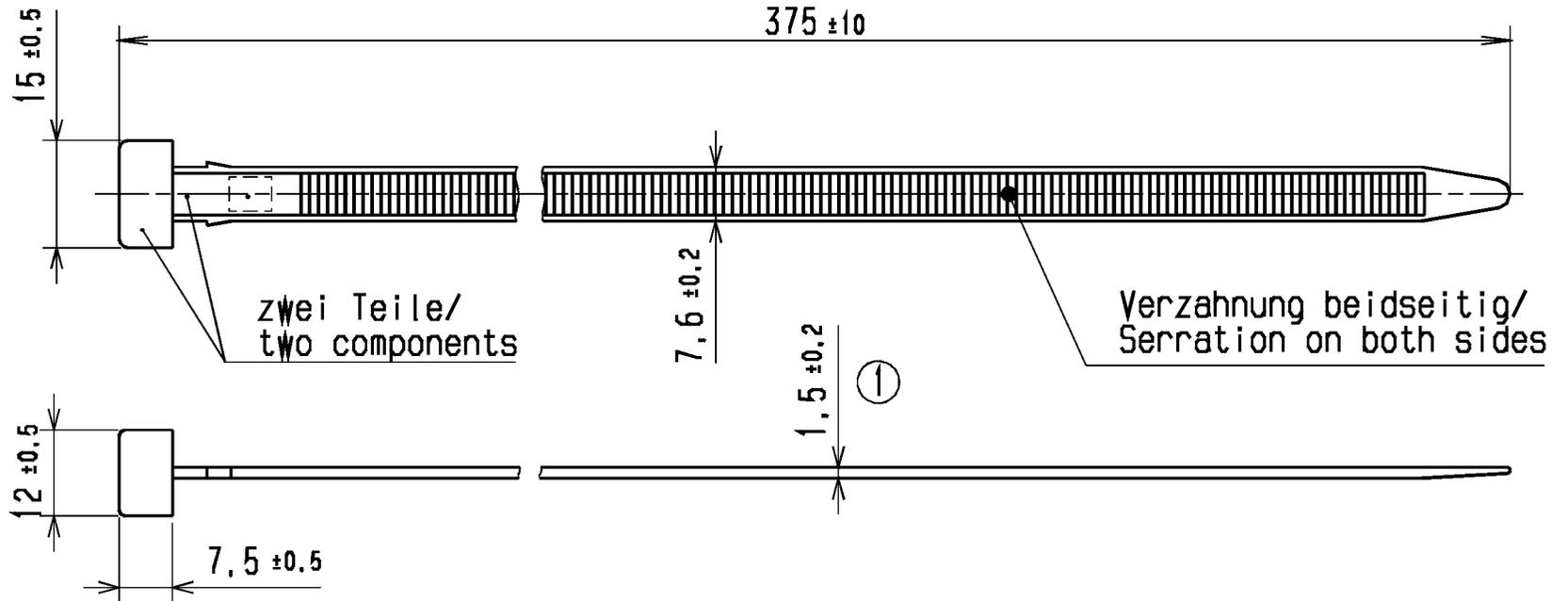
Kabelbinder ist beidseitig einschlaufbar, im lose montierten Zustand loesbar
