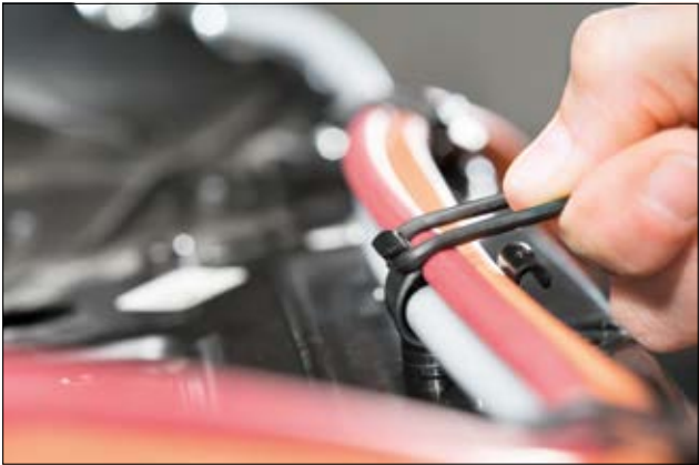
Abraçadeira Berço - fixação de 2 peças que consiste em abraçadeira e anel de retenção. O método simples e versátil de agrupar cabos.
