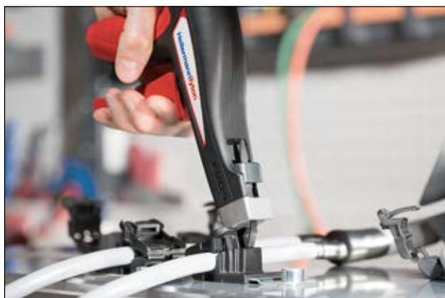
A tira de tensão pode ser usada para garantir uma tensão específica.
