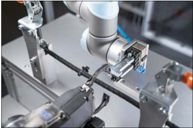
Aplicação de clips automatizada.
