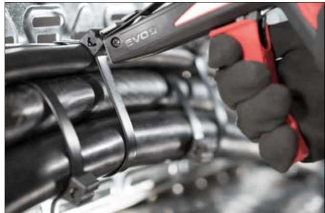
As correias EL-TY podem ser cortadas para adequação a qualquer feixe com a ferramenta de aplicação EVO9.
