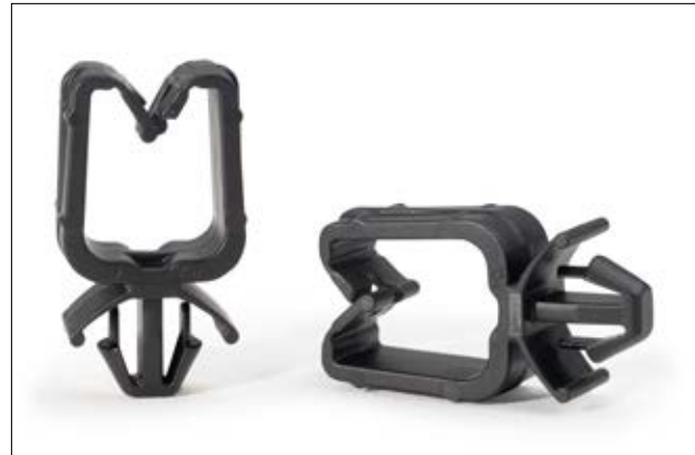
Clipe para arnês em polipropileno com cabeça de seta para furos redondos de 6,3 mm.
