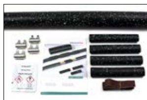
LVK-C: Manga externa, manga interna, conectores mecânicos, pano de limpeza, lixa, instruções de instalação.
