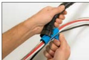
Coloque a ferramenta aplicadora HAT numa extremidade do organizador de cabos Helawrap.
