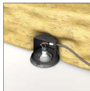
4. Eristysmateriaali voidaan asentaa.
