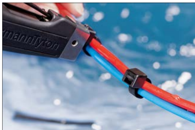
T-serie bundelbanden met een hogere chemische bestendigheid en tot temperaturen van +115 °C (PP).
