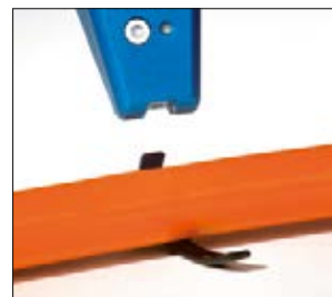
4. Løft CUTties, kabelbinderen er klippet op.
