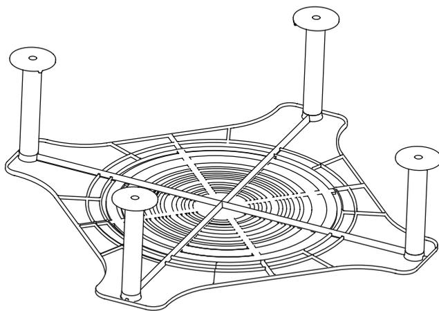
SpotClip-Plate installé avec 4 SpotClip-Tubes et 4 SpotClip-Caps
