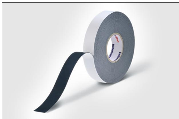
HelaTape Power 810 è un nastro in gomma etilenpropilenica di 0,76 mm autoagglomerante, consente isolare giunti fino a 69 kV.
