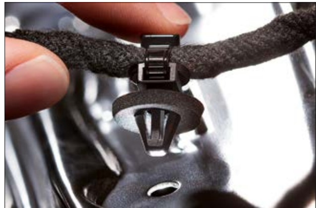
Uszczelka chroni otwór montażowy przed wnikaniem wilgoci.
