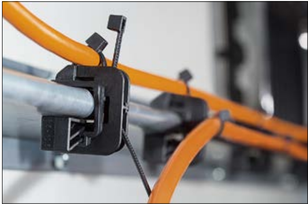
Beam Clamp można zamocować na belce za pomocą klina. Na górnej lub tylnej stronie obejmę mogą być ułożone maksymalnie dwie wiązki.
