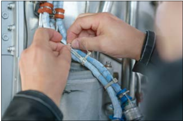
Zewnętrznie ząbkowana opaska kablowa i szyld oznaczeniowy HFTP48 wykonane z materiału PEEK.
