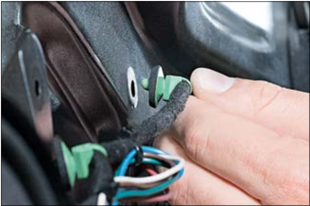
Uszczelka chroni otwór montażowy przed wnikaniem wilgoci.
