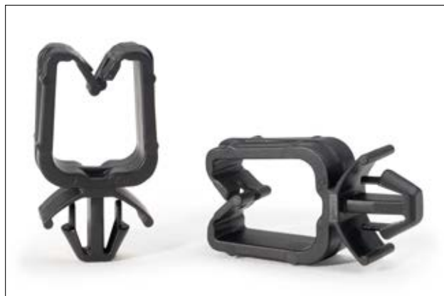
Uchwyt do wiązek wykonany z polipropylenu z mocowaniem kotwicowym do otworów okrągłych 6,3 mm
