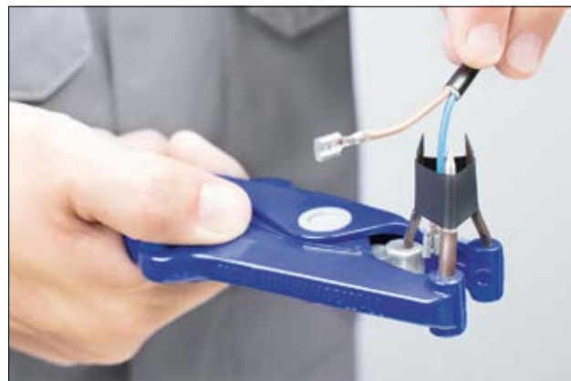
Szybka i bezpieczna aplikacja oznaczników i tulejek przy pomocy rozwieraka trójkębego.
