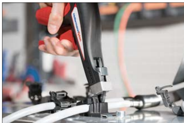
Kiristysliuskalla varmistetaan kaapelikiinnikkeen haluttu kiristysvoima.
