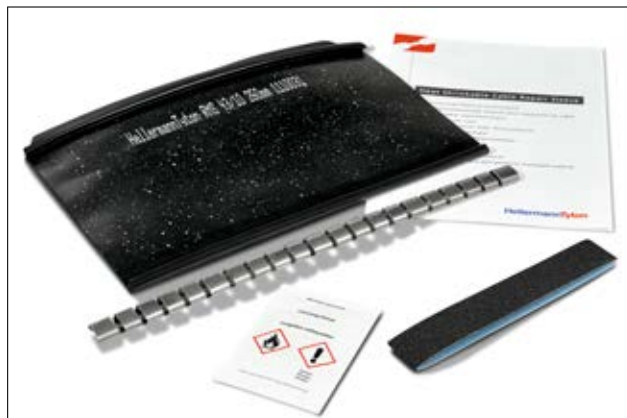
RMS-pakkaus sisältää: kaapelin korjauskääreen, haponkestävän teräskiskon (SS316) kääreen sulkemiseen, hiontapaperin, puhdistuspyyhkeen ja asennusohjeen.
